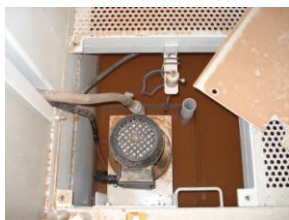
Pompa per refrigerazione disco alloggiata nella vasca a ciclo continuo.
