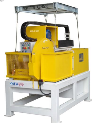
Ogni macchina viene corredata da un accessorio di sollevamento dotato di 4 pendenti a fune d'acciaio, in modo da poterla sollevare in modo bilanciato e senza creare interferenze fra funi di aggancio e struttura della macchina e per agevolare la sua movimentazione da un cantiere all'altro.
