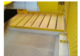
Banco portapezzi, completo di supporti di riscontro regolabili con funzione di appoggi.
